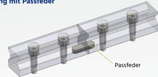
Zur Vereinfachung der Montage können die Schienen mit einer Passfedernut an der Stoßstelle geliefert werden. Die Passfeder ist in der Schiene versenkt, die Schienen können direkt auf einer ebenen Fläche aufgeschraubt werden.
